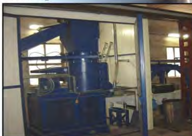
Linka recyklace LCD a plazma obrazovek: 250 kg/hod
