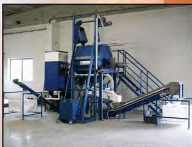
Linka čištění CRT sklovin: 500 kg/hod
